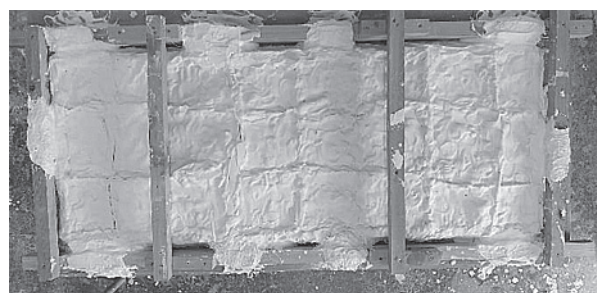
写真 12 針金と垂木で補強した石膏雌型
