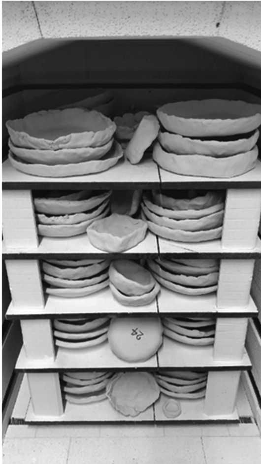
写真14 豆皿(大)(小)を電気陶芸窯で800°C素焼き焼成する様子
