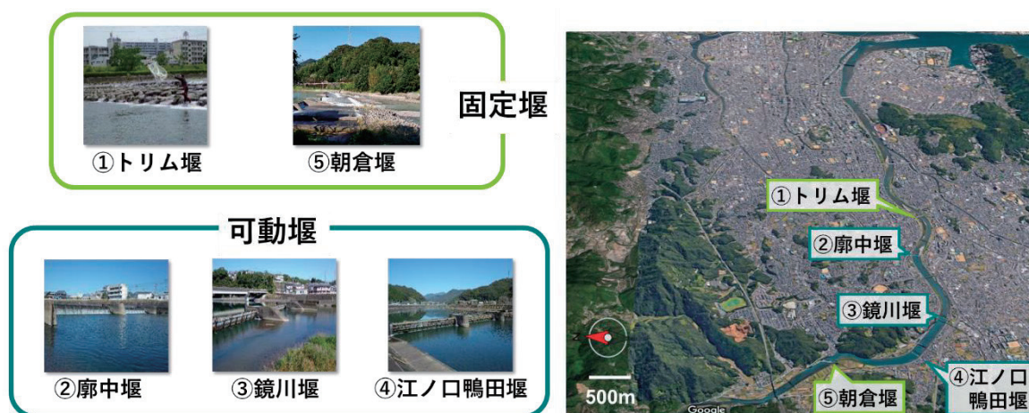
Fig. 1. 鏡川下流域に設置された 5 基の取水堰. 河口側からトリム堰, 廓中堰, 鏡川堰, 江の口鴨田堰, および朝倉堰. うち, トリム堰と朝倉堰は固定堰, 廓中堰, 鏡川堰, 江の口鴨田堰, および朝倉堰は可動堰となる.
