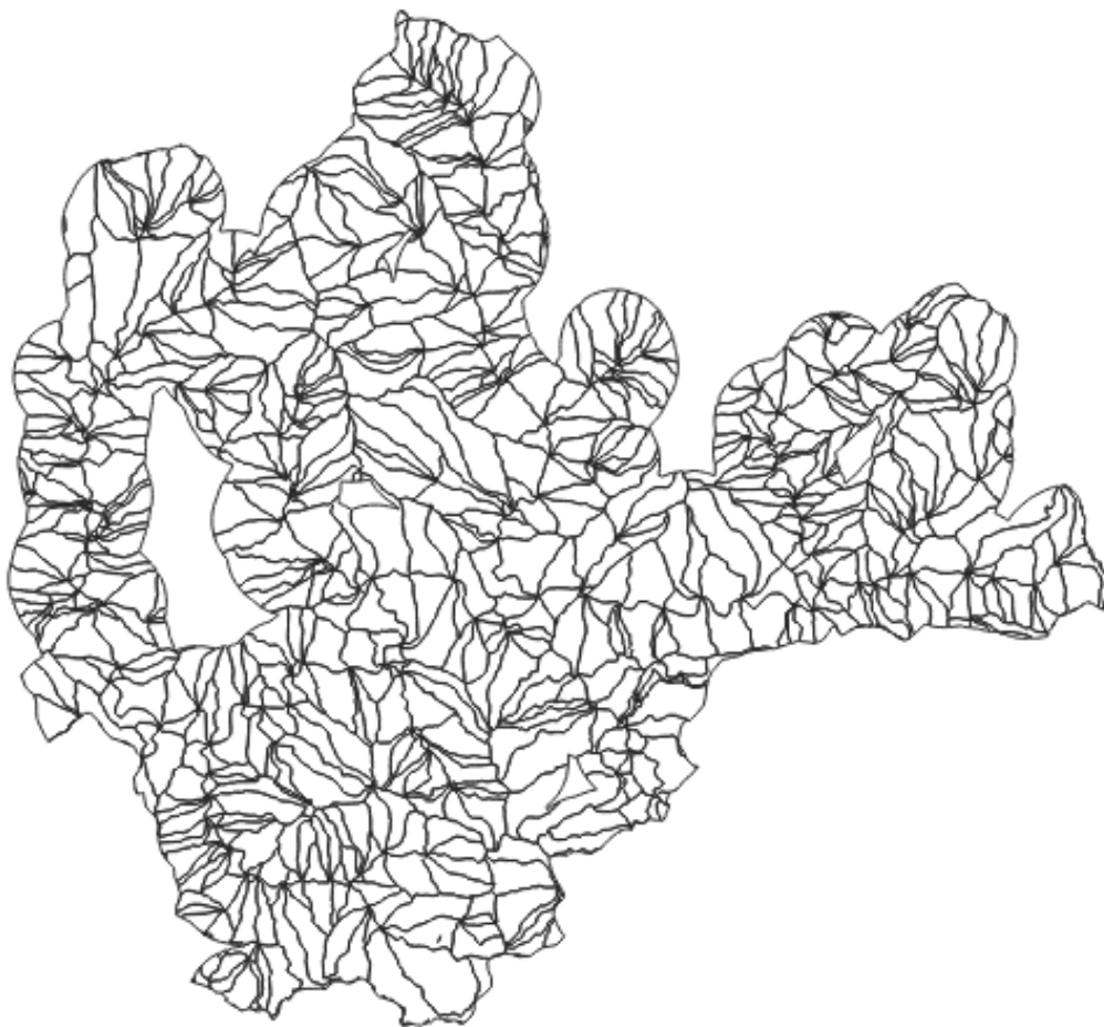
図 5-3. 集水域ポリゴンと道路からのバッファの交差結果（最小周長 1,860 m）
