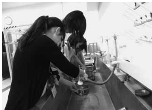
シャワーとふるいを使って 堆積物から有孔虫を取り出す
