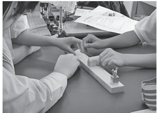
図12 音の大小・高低と弦の振動との関係の観察
