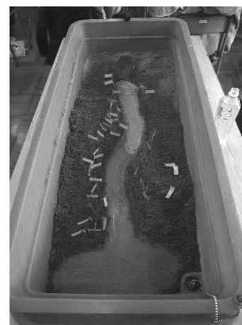
図1 流水実験器
