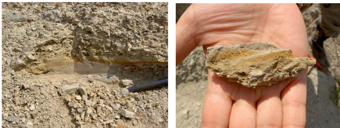
写真 3.4.2.9 差別浸食を受けた芝生衝上下盤土柱層のシルト層の産状とその岩片 本地域のシルト層は元来白色を呈するが、ここでは特徴的に酸化し褐色を帯びている。
