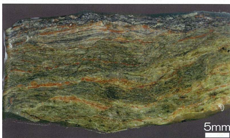
図 5.4.6.2 淡褐色の「破砕物」と黒色粘土の境界付近の研磨片試料 赤矢印は黒色粘土が貫入している箇所を示す。
