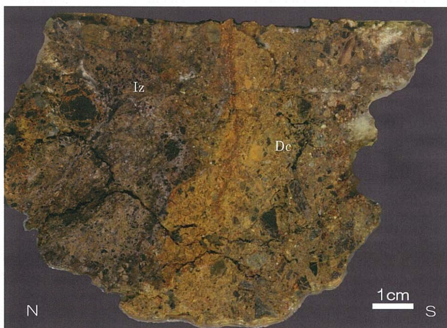
図 5.4.2.3 和泉層群/土柱層境界（露头 A）の断層ガウジの研磨面 （Iz：和泉層群，Dc：土柱層）
