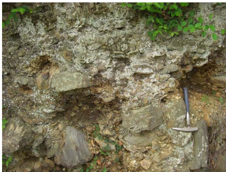
写真 4.3.2.3 (1) 白地橋西方の土柱層基底礫 結晶片岩類および和泉層群岩類の亜角礫～亜円礫からなる礫層である。
