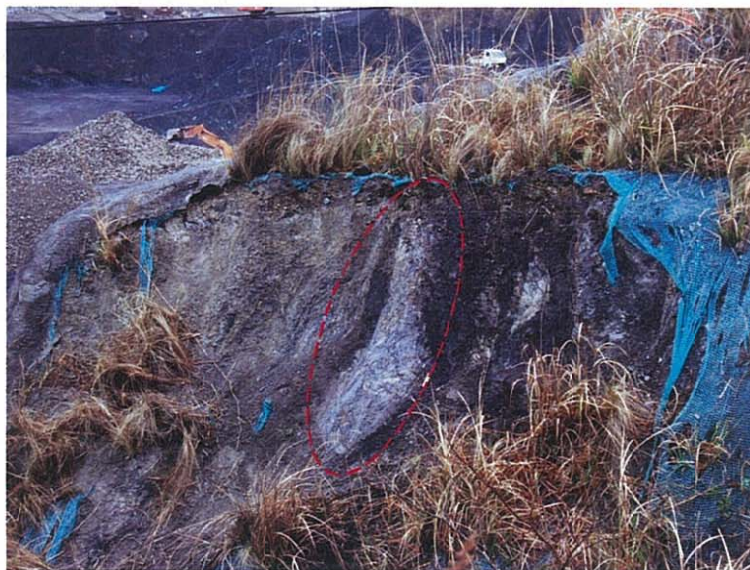
写真 5.4.6.1 優白色の結晶片岩粘土（枠内）を混在する黒色の和泉層群粘土
