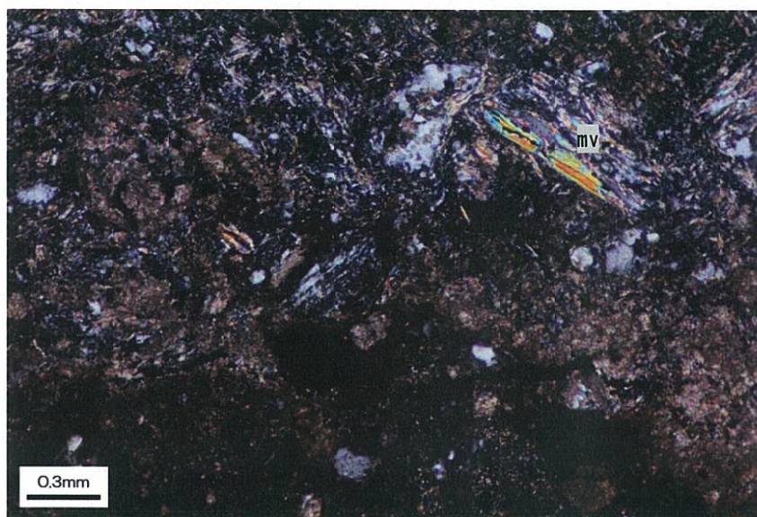
図 5.6.1.2 芝生衝上の断層ガウジ中に混入する結晶片岩の岩片と白雲母片 (mv) (クロスニコル)
