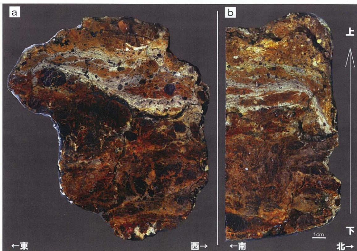
図 5.4.7.1 芝生北露頭の断層試料（a：東西研磨面，b：南北研磨面）
