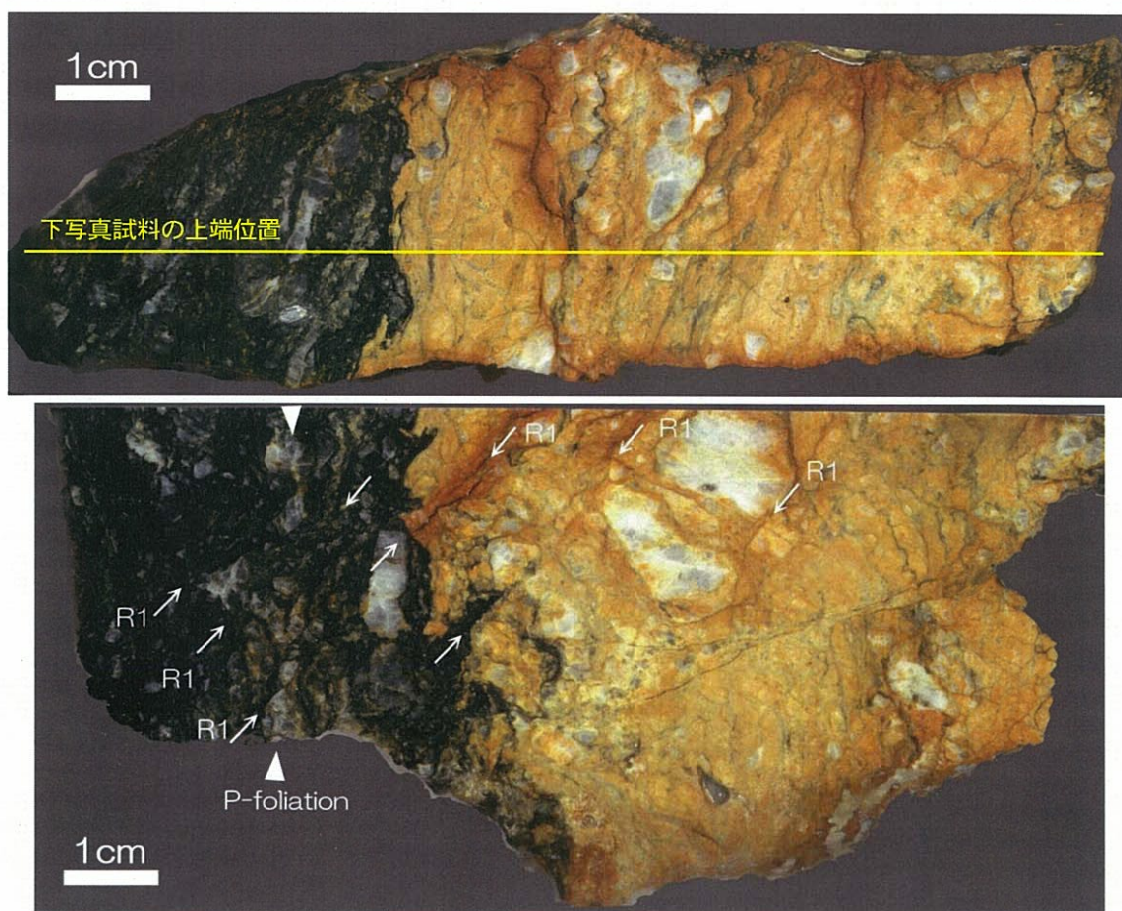
図 5.4.13.2 湯谷口における黒色粘土・熱水脈境界（転石）の研磨面
