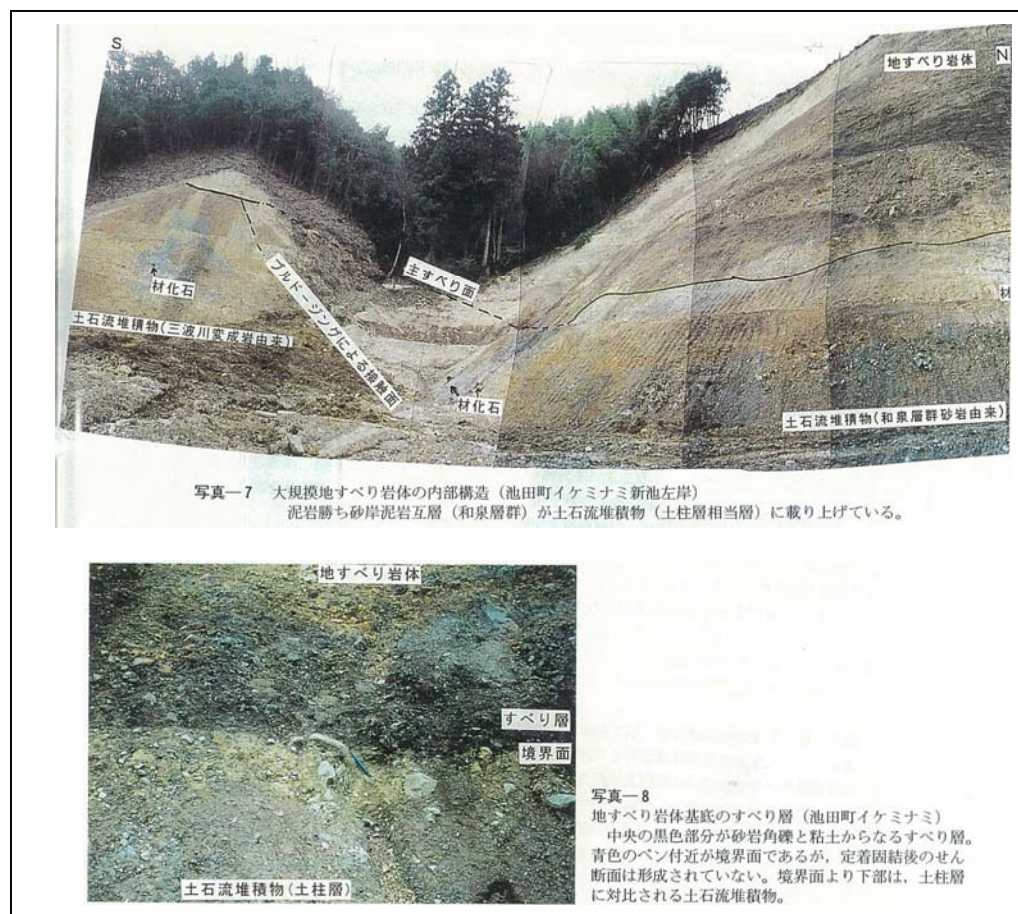
写真 4.6.5.1 シンヤマの破碎（地すべり）岩体下位には礫層が存在する（長谷川，1999）
