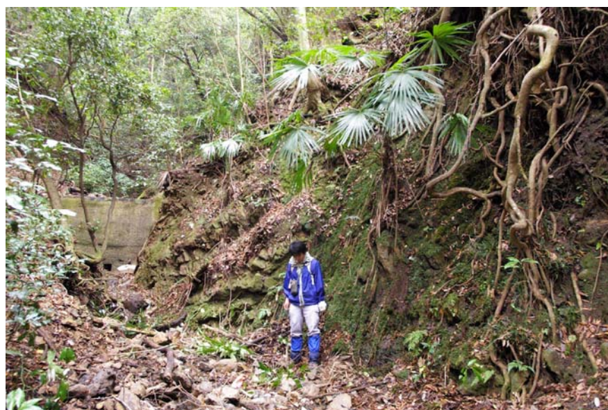
写真 4.5.1.2 落倉谷屈曲部の露頭状況（撮影位置は前頁図に掲載） 砂岩を主体とする和泉層群に，幅十 m を超す顕著な破碎帯はみられない。
