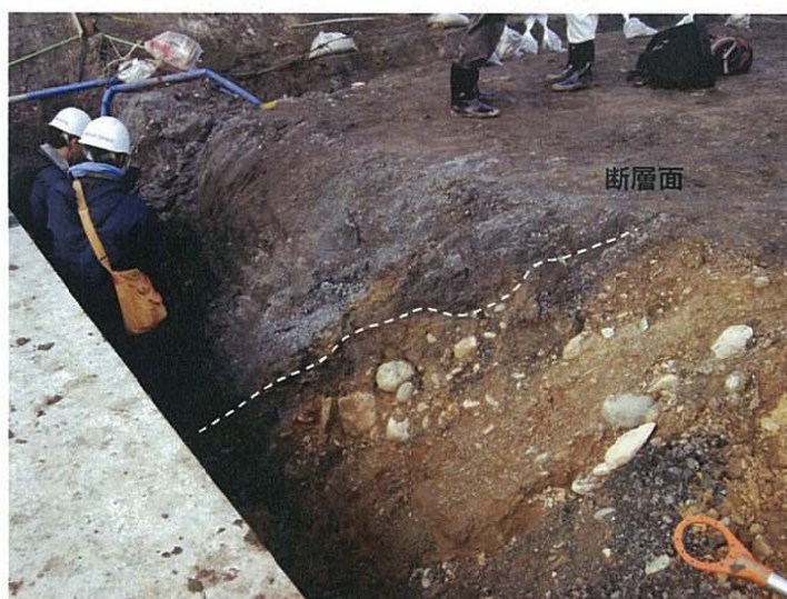
写真 5.4.10.1 露頭周辺の様子（東方を望む） 白破線が境界断層の位置を示す。
