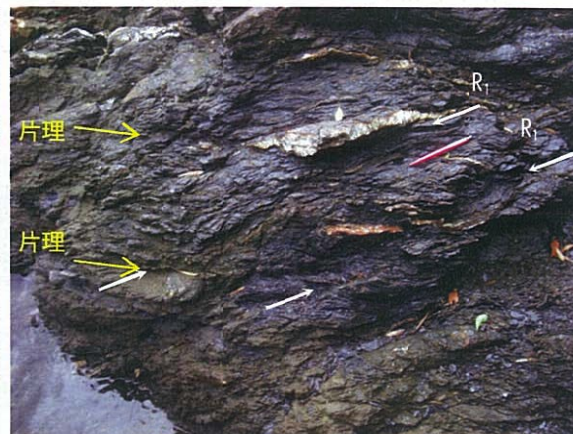
写真 5.4.13.7 三波川結晶片岩の破碎帯（左写真「破碎片岩」部の近接写真）
