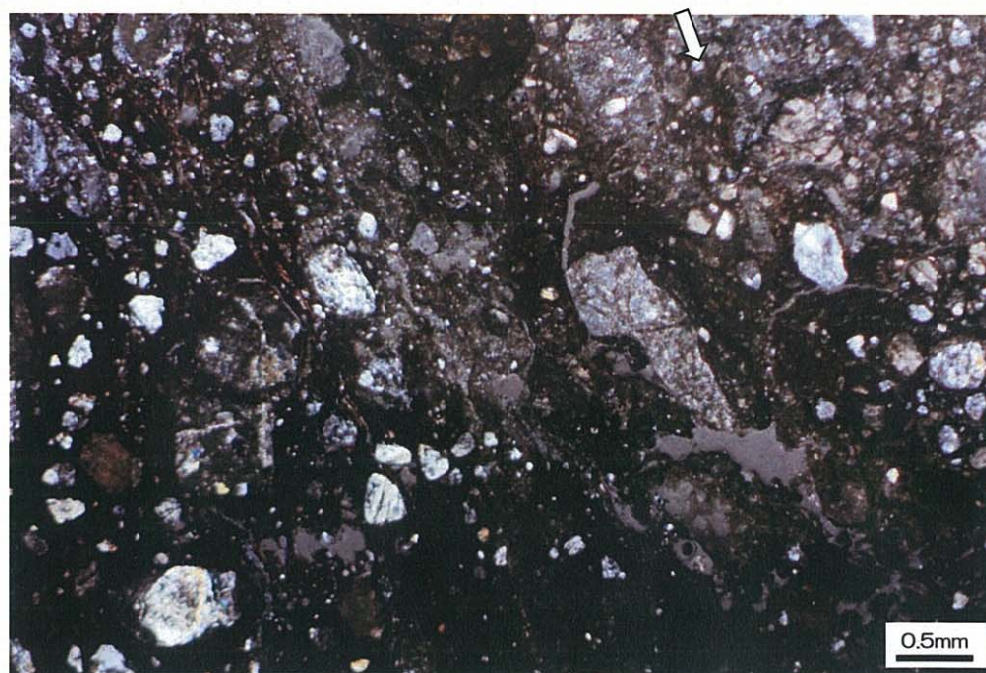
図 5.4.1.4 土柱芝生谷の断層ガウジの偏光顕微鏡写真（クロスニコル）
