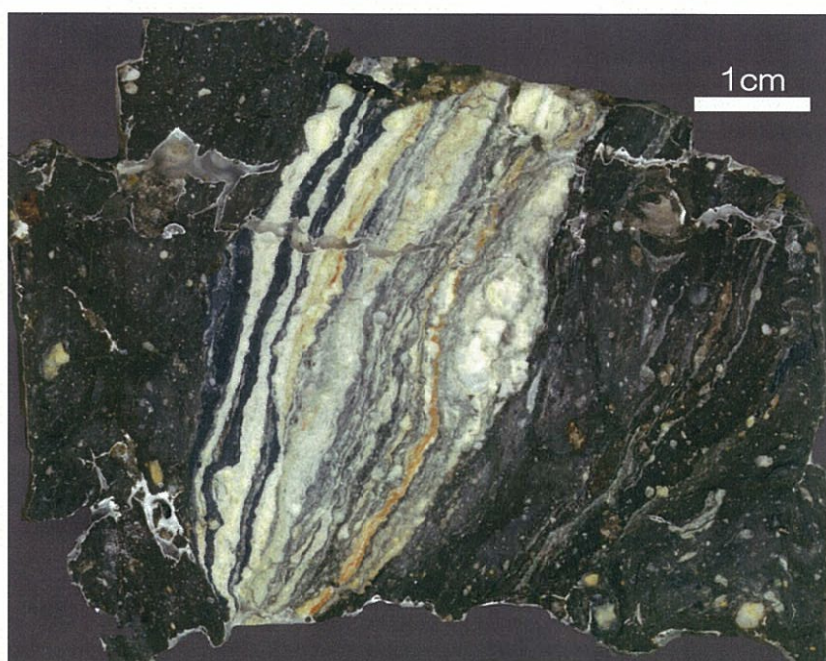
図 5.4.5.3 芝生衝上の暗青灰色粘土にみられる縞状組織の研磨試料 矢印は衝上断層として移動方向を示す。
