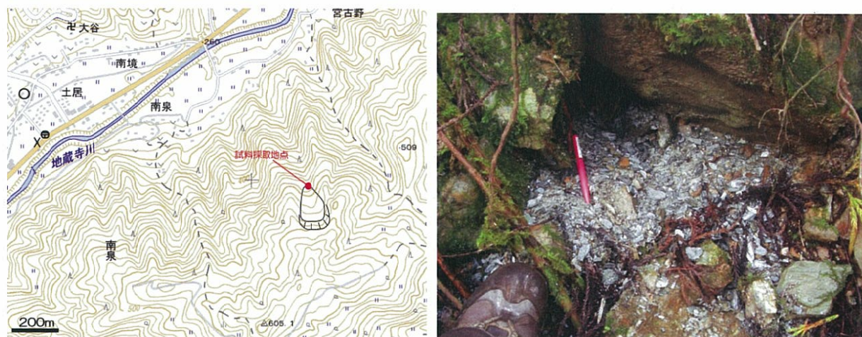
図 5.5.1.1 左：調査地周辺の地形図と地すべり範囲，右：すべり面粘土の露頭状況 地形図は国土地理院 2.5 万分の 1 地形図「田井」に加筆使用した。
