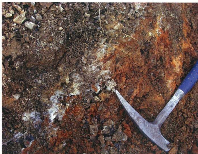
写真 5.4.7.2 芝生北方の土取場跡の断層面に挟まれる白色粘土
