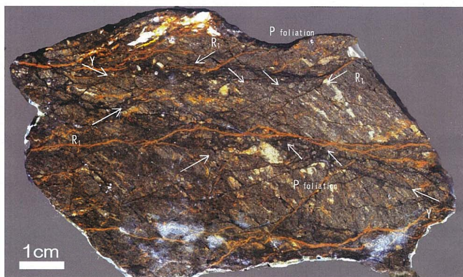
図 5.4.14.2 砥部衝上北側の黒色粘土の研磨サンプル (転石により不定方位)
