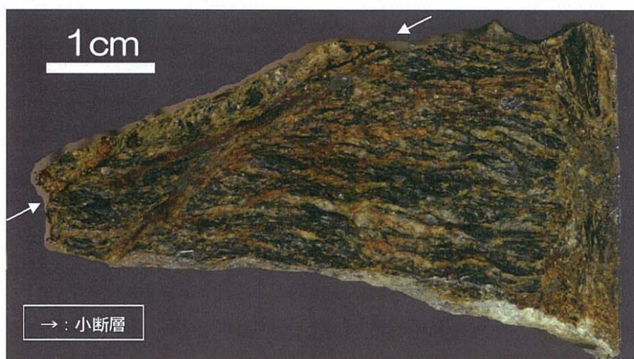
図 5.4.12.2 (1) 「川滝衝上」における破碎した泥質片岩の研磨片
