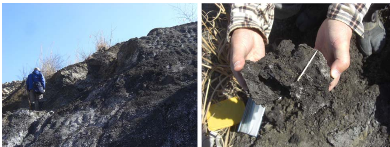
写真 3.3.2.1 芝生北方の大規模土取場に露出する破碎した和泉層群 黒色粘土かした部分が多く、露頭全体が暗色を帯びている。
