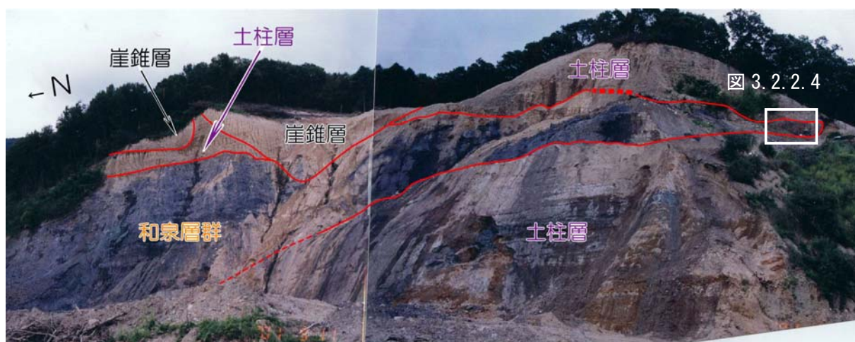
写真 3.2.2.3 中上露頭に現れた下位低角度断層（中野，2002 の写真に加筆）
