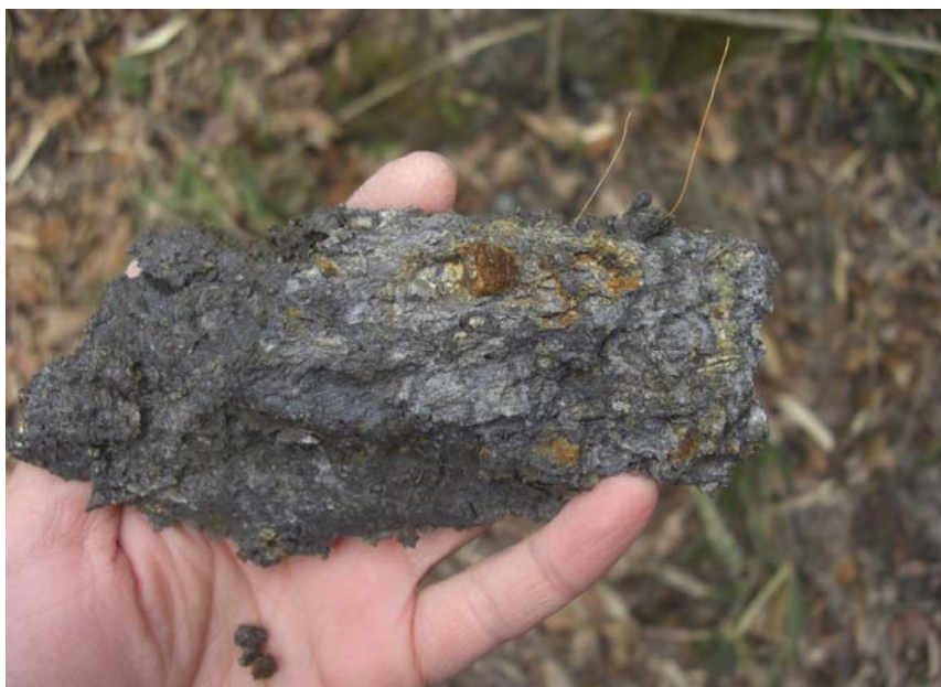
写真 3.4.1.2 勢力地区 Loc.1 における低角度断層露頭（上）と断層粘土（下）
