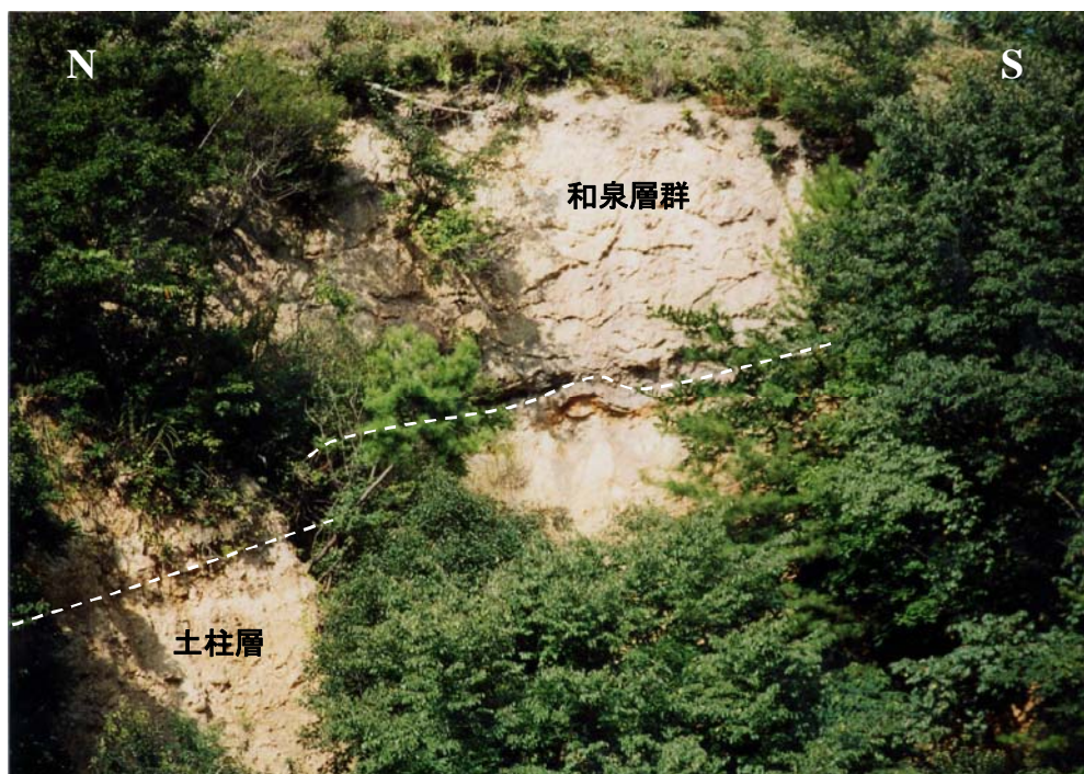
写真 4.6.6.1 中野谷川西地すべり末端のすべり面（破線部） 前頁図の B 地点で撮影。
