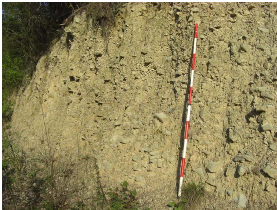
写真 3.3.2.3(3) タイプcの土柱層（上野地区）
