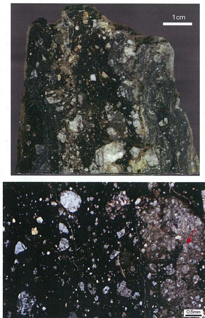
図 5.4.10.2 上：南北方向の切断研磨面，下：同薄片（クロスニコル）
