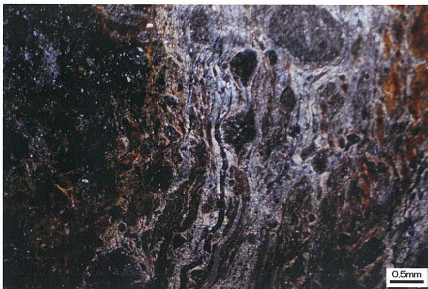
図 5.4.7.2 白色粘土付近の偏光顕微鏡写真（クロスニコル）
