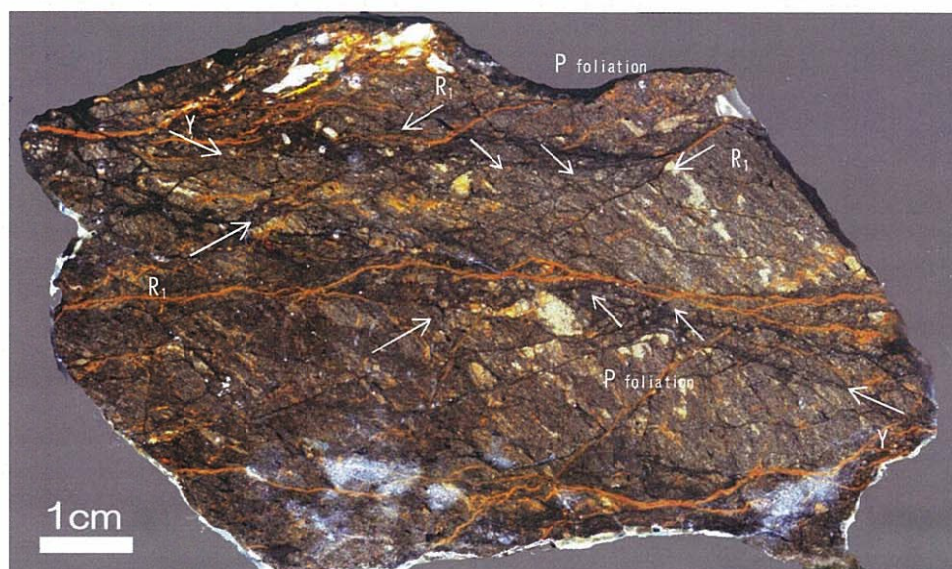
図 5.6.1.1 断層ガウジにみられる複合面構造の例(砥部衝上)
