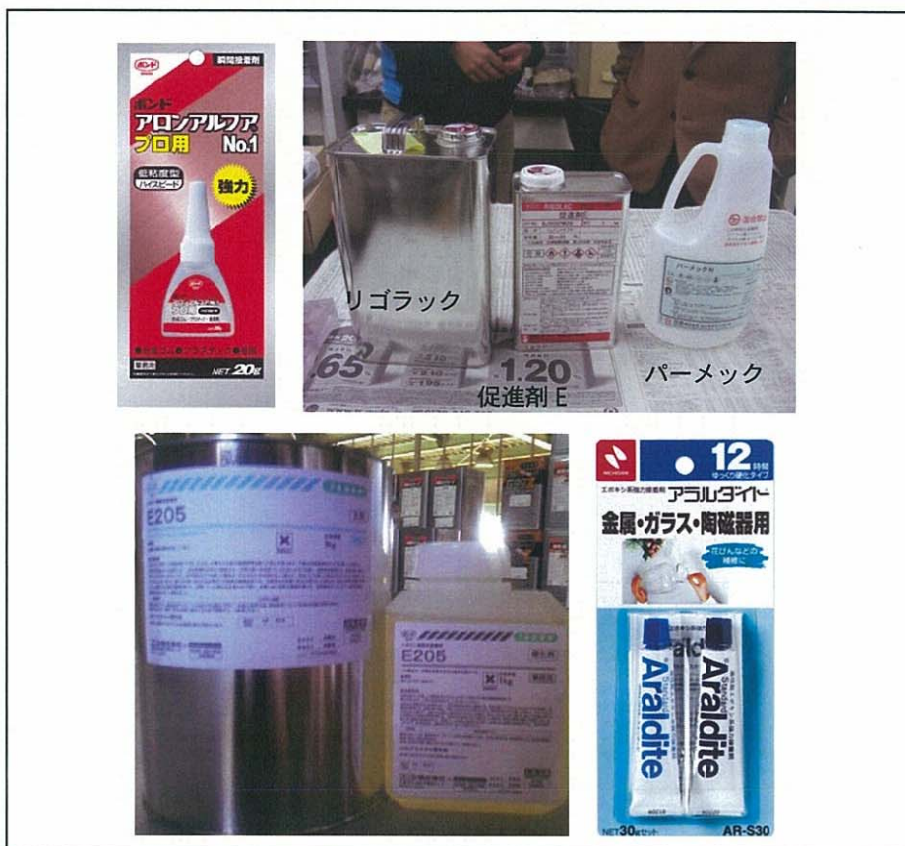
写真 5.3.1 サンプルの採取・固化処理に使用する薬剤 上段，左よりアロンアルファプロ用 No.1，リゴラック+パーメック N。 下段，左より E205（主剤・副剤），アラルダイト。
