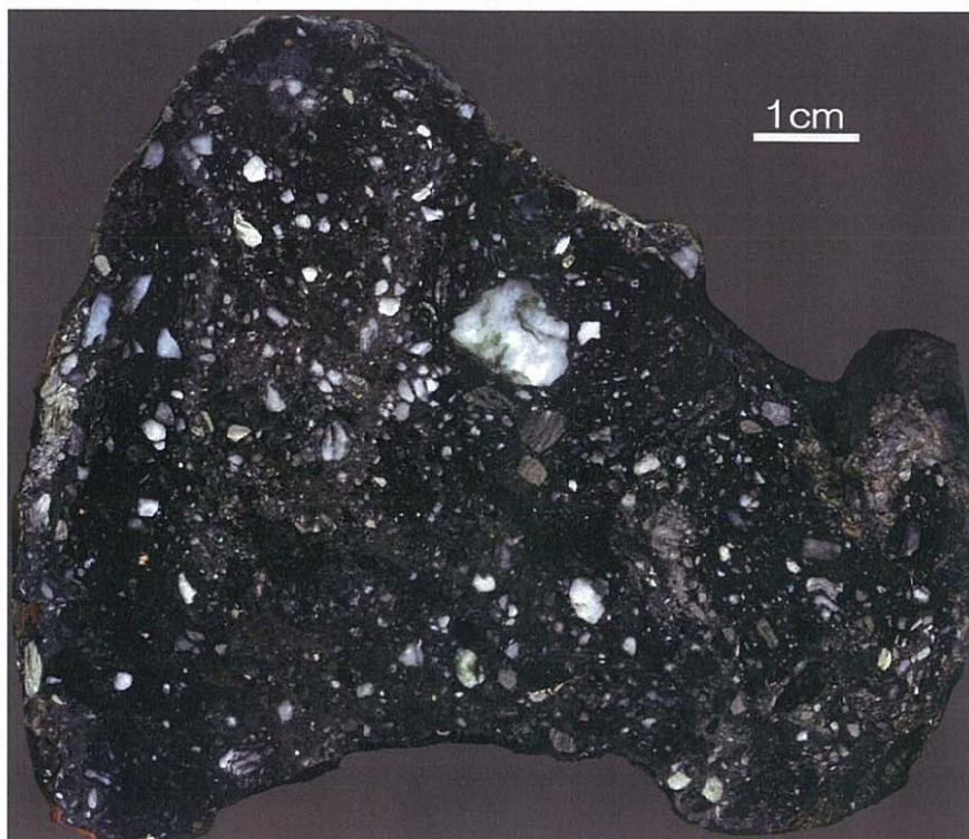
図 5.5.2.2 すべり面粘土の研磨面（不定方位，上下不明）
