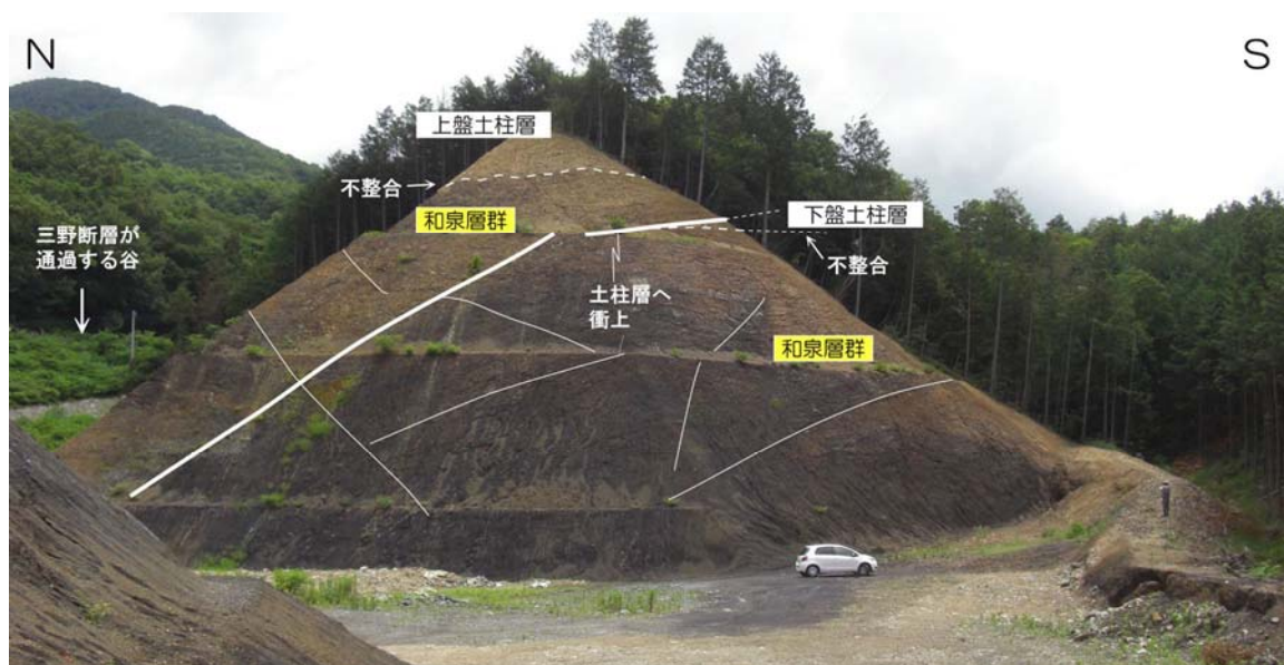
写真 3.4.2.2 芝生北方の土取場跡（Loc.2）の壁面にみられる断層（実線）と不整合（破線） 上盤土柱層に不整合に覆われた和泉層群破碎帯が、下盤土柱層に衝上している。
