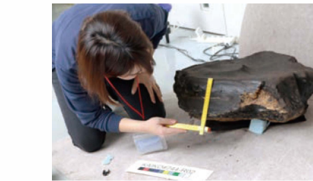
図1:拓洋第3海山から採取されたコバルトリッチクラスト(厚さ約13cm)
