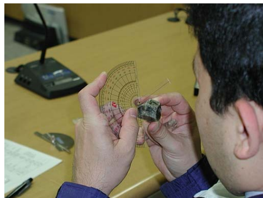
図5. ザクロ石における隣接 (稜を共有) する結晶面の交角測定. この角度は 120^\circ とみなせそうだ。
