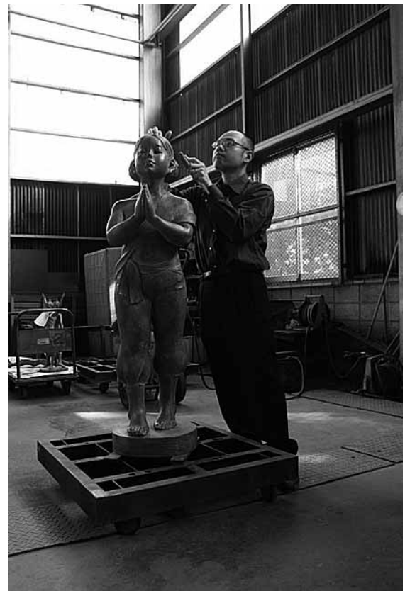
写真8 ブロンズ像への着色作業
