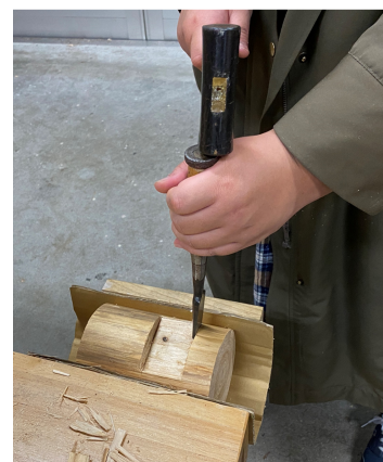
図6. のみにより周囲を切り込む様子 (繊維方向と直角な方向) Perimeter being cut by chisel (direction perpendicular to fiber direction)
