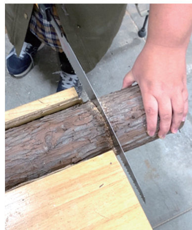
図1. のこぎりによる丸太材の切断 (Cutting a log wood with a saw)
