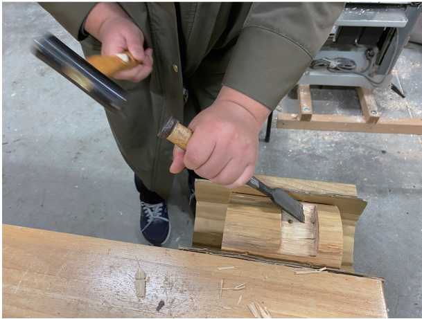
図7. のみによる切削加工の様子 (Machining with a chisel)
