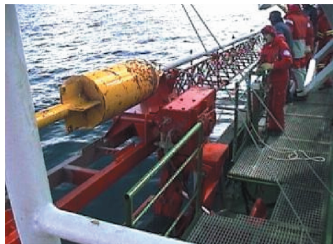
図5 上甲板中央部左舷側にとりつけられたグラビティコアラーと専用コア架台。 Fig. 5. Gravity corer and its support structure on the port side of the upper deck of the R/V Itatica.
