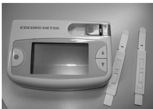
写真5 ストレス度測定器とチップ
